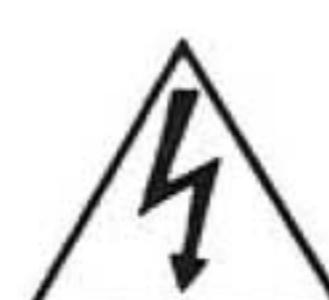
Der Blitz mit dem Pfeil an der Spitze in einem gleichschenklichen Dreieck soll den Benutzer vor nicht isolierter "gefährlicher Spannung" im Produkt warnen, die eine Stromschlaggefahr für Personen darstellen kann.
