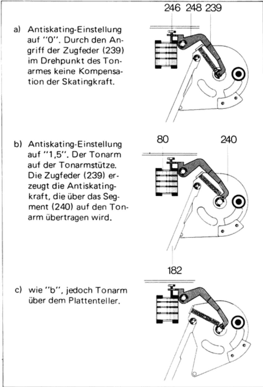
a) Antiskating-Einstellung auf "0". Durch den Angriff der Zugfeder (239) im Drehpunkt des Tonarmes keine Kompensation der Skatingkraft.
