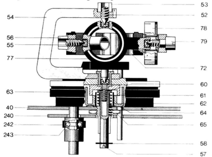
Fig. 12 Tonarmlagerung Unteransicht
