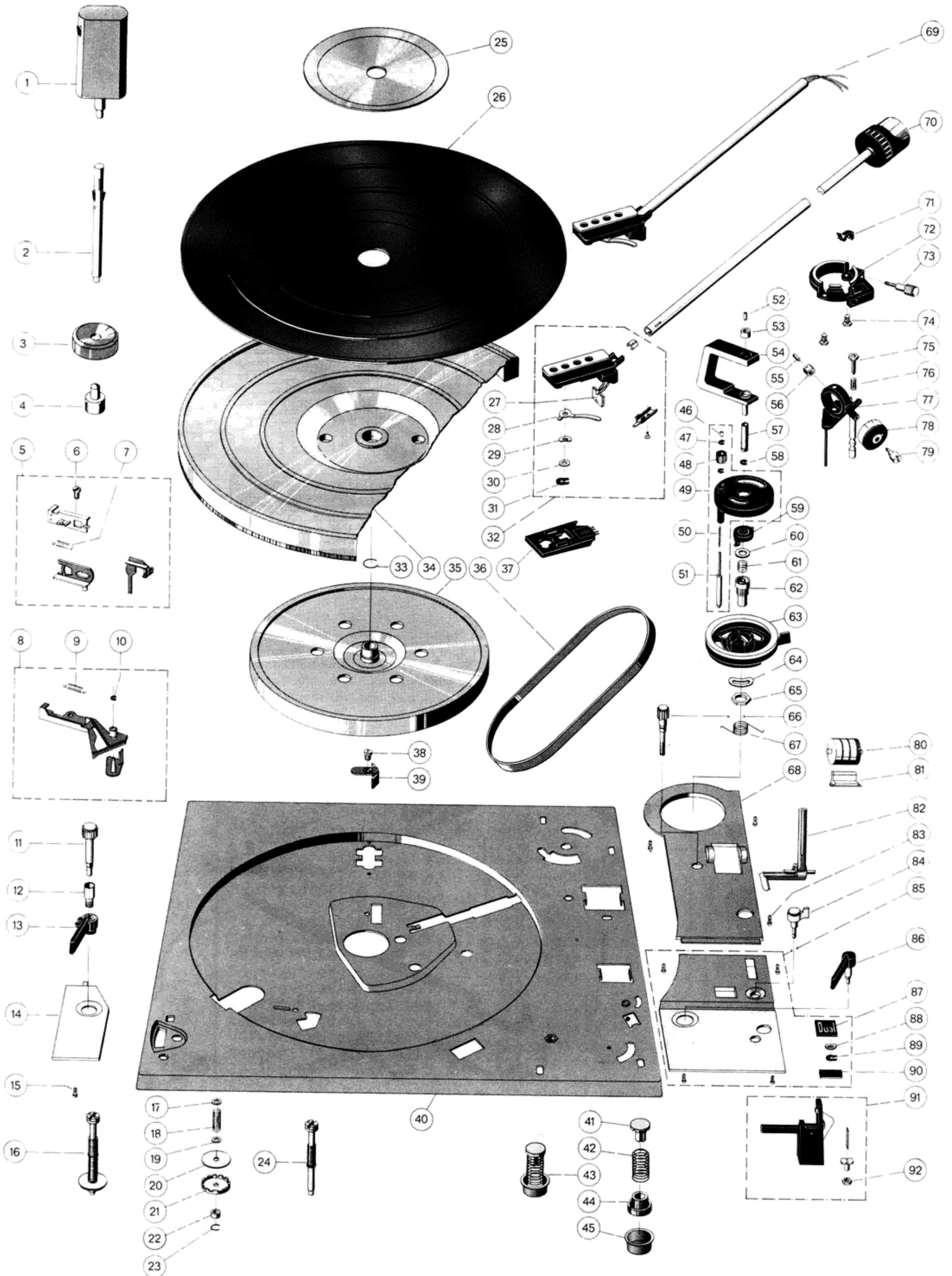
Fig. 25 Explosionszeichnung, Teile unter der Platine
