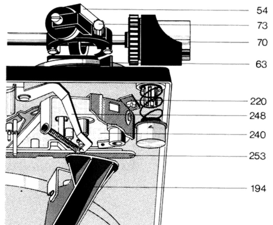
Fig. 13 Antiskatingkraft
