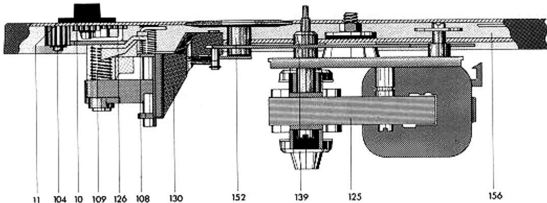
Fig. 3 Motoraufhängung und Antrieb des Plattentellers Dual 1222
