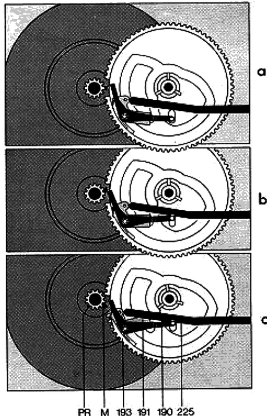
Die Abwurfkurve ist am Kurvenrad so angeordnet, daß der Abwurf einer Schallplatte nur erfolgen kann, wenn sich der Tonarm über der Stütze, also außerhalb des Bereiches des größtmöglichen Schallplatten-Durchmessers (30,5 cm) befindet.
