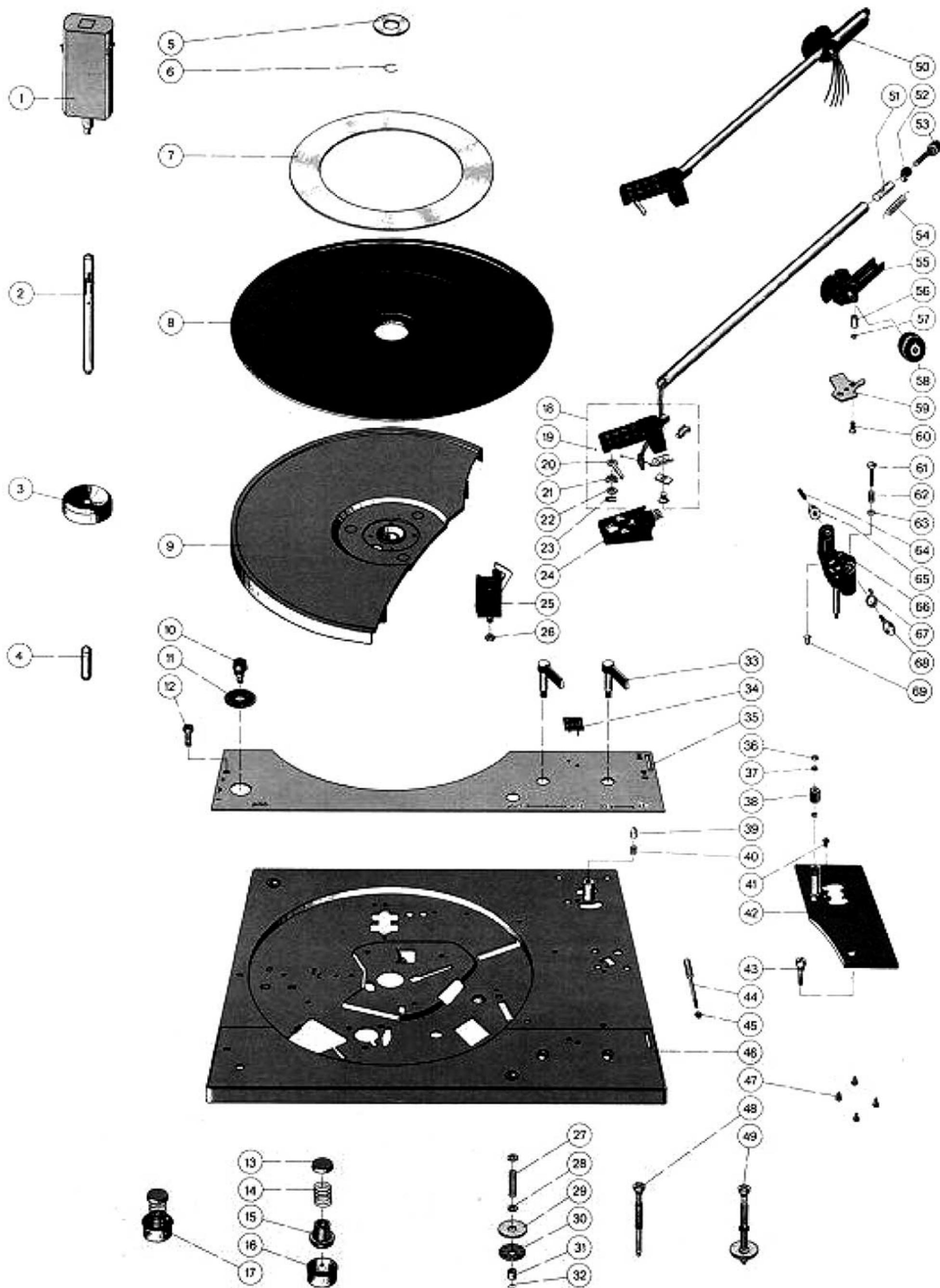
Fig. 25 Explosionsdarstellung, Teile unter der Platine
